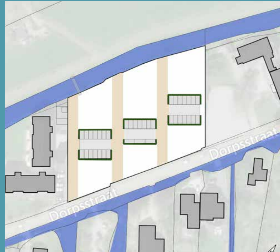
Parkeren verspreid en uit het zicht van openbare ruimte in compacte parkeercoffers
